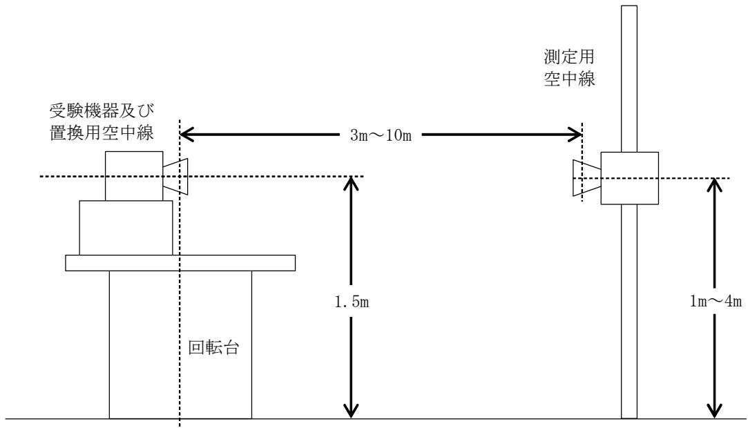
ア 受験機器及び置換用空中線は空中線の中心が回転軸上になるように回転台上に乗せ、地上高は1.5m（空中線の中心）とする。台の材質及び受験機器等の設置条件は、ETSI EN 303 980等に準じる。
