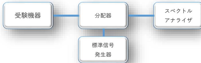
(2) 外部試験装置を用いて試験を行う場合
