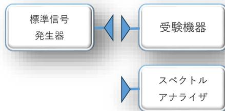
(2) 外部試験装置を用いて試験を行う場合
